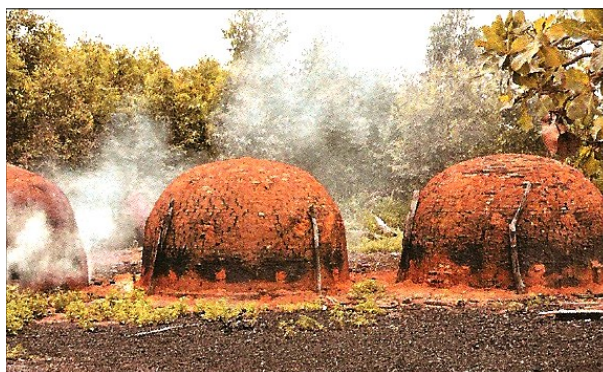
Figura 15. Fornos de barro utilizados para a produção de carvão vegetal em Luziânia – GO, 2009
